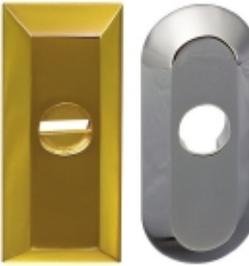
Sicherheitsrosette aus hochwertigem Werkzeugstahl gefräst und gehärtet. Oberfläche in Ni pol., Ni matt und Ms pol. erhältlich. Rosette mit oder ohne Kernziehschutz lieferbar. Der Kernziehschutz erschwert durch eine eingelegte Stahlplatte das Ziehen des Zylinderkerns.
