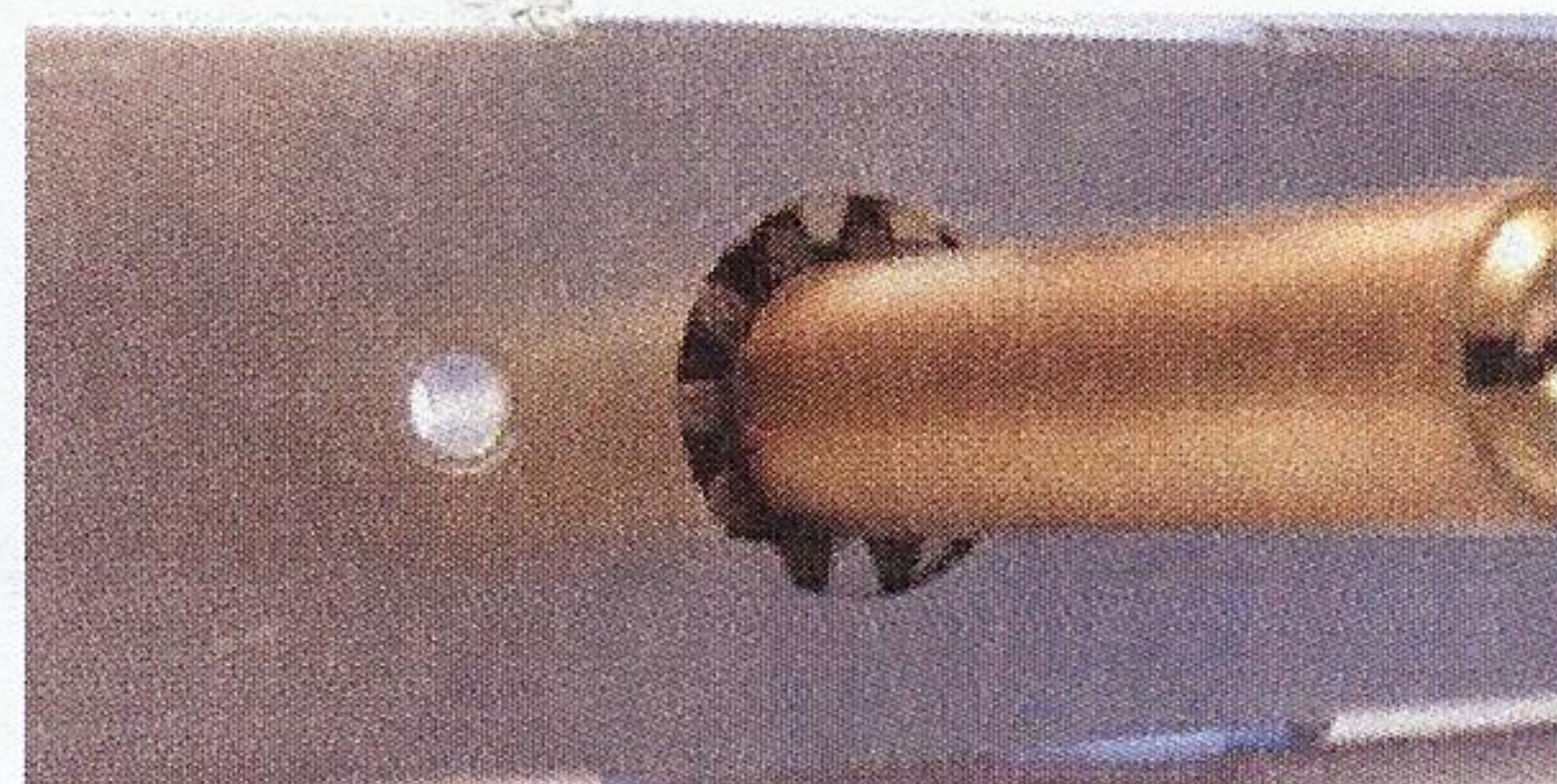
Foto 3: Zahnritzel des Doppelzylinder in die letzten beiden Zähne der Zahnstangen einhängen
