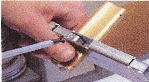
Foto 2: Befestigung des EDZ im Schlosskasten
