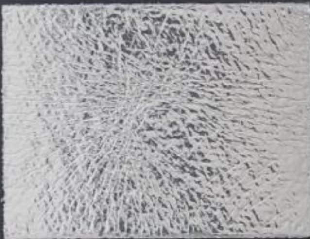
JK I25 Plus – 3 mm PU/Mineral/Alu-Spezialunterlagsmatte (Dichte ca. 1 to/m³)
