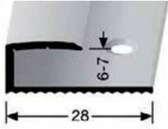
**Trennfugenprofil für Laminatboden**
