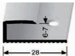
**Trennfugenprofil für Laminatboden, Typ 192 (Bestellsortiment)**
